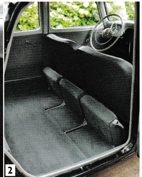
2. Quand ils ne servent pas, les trois strapontins s'encastrent dans une cavité du plancher.
