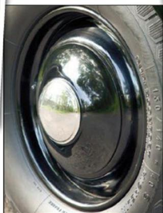
Jantes pleines en tôle à bord arrondi. C'est la roue "Stop" dérivée de celle qui équipait les Rosalie. Elles sont dotées d'un enjoliveur à calotte chromé clipsable et ont été prévues pour les pneus Superconfort, développés par Michelin.
