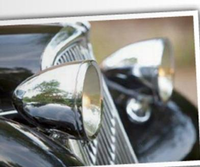
Jusqu'au 15 mai 1934, le bord intérieur des ailes est roulé. A partir de cette date et sur notre modèle, il est en gouttière.
