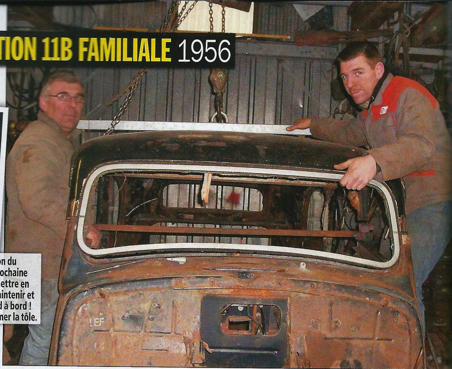
Le gros du travail s'est concentré sur la carrosserie en très mauvais état et déformée par le grappin
