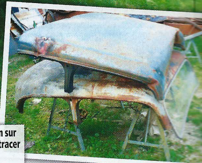
En attendant, nous avons réalisé un conformateur à base de tubes carrés que nous avons soudé à la carrosserie pour qu'elle ne se vrille pas, le temps de redonner son intégrité à la coque.
