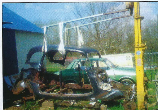
Après plusieurs mois de recherches, nous finissons par dénicher une voiture donneuse dont nous prélevons le pavillon, une autre familiale.
