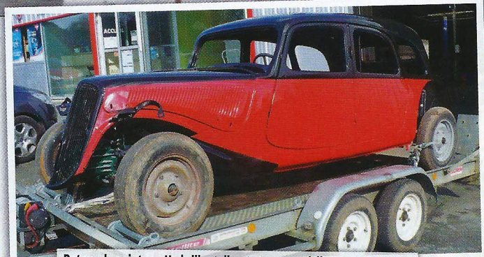
Retour de peinture. Un brillant direct et, pour qu'elle pête encore plus, nous avons poncé intégralement la carrosserie au 500 à l'eau afin d'appliquer un vernis de haute qualité. Résultat : un effet miroir !
