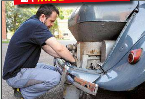
Avant de lancer la machine, il faut enlever les cendres, comme on le ferait avec un insert de cheminée. L'opération s'effectue une fois par jour.
