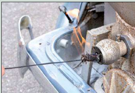
Pour mettre le feu, on approche une torche de cet orifice pourvu d'un clapet. L'aspiration générée par le ventilateur (situé dans le compartiment moteur) avale la flamme et active instantanément la combustion du charbon.
