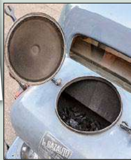
Pour faire le plein de charbon, rien de plus simple. On ouvre le couvercle au-dessus de la trémie, puis on vide les sacs.
